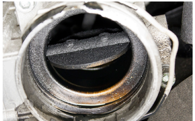
Зображення 1: Необхідно почистити дросельний вузол від забруднення
