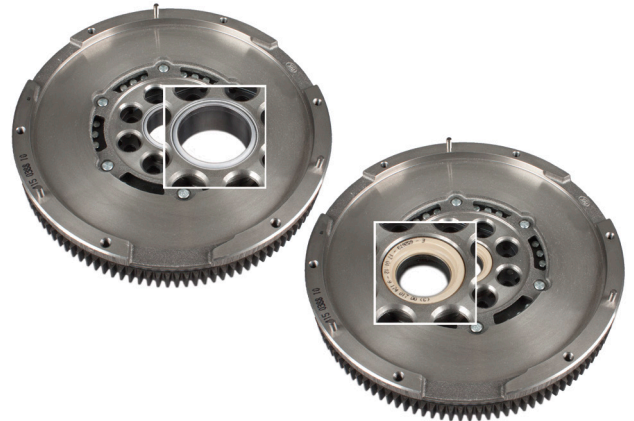
Εικόνα 1: Σύγκριση του ΒΔΜ 415 0388 10 με κουζινέτο (αριστερά) και ρουλεμάν (δεξιά)
