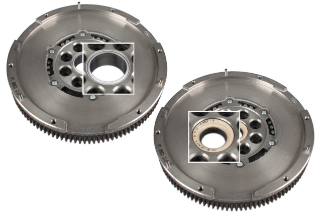
Kuva 1: LuK ZMS 415 0388 10 liukulaakerilla (vasemmalla) ja kuulalaakerilla (oikealla) vertailussa
