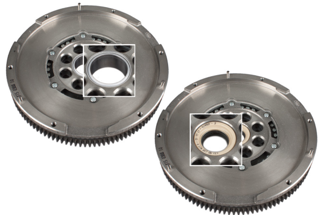
Figur 1: Sammenligning av LuK DMF 415 0388 10 med glidelager (venstre) og kulelager (høyre)
