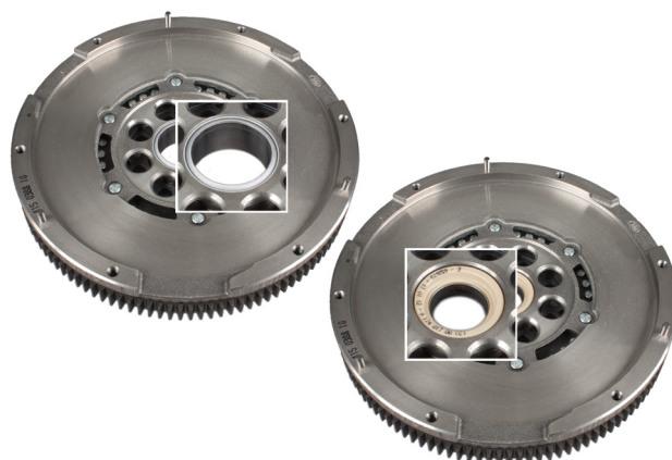
Bild 1: Jämförelse mellan LuK DMF 415 0388 10 med glidlager (vänster) och med kullager (höger)
