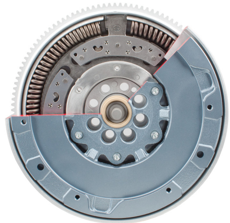
Kuva 1: Keskipakoisheilurilla varustettu kaksoismassavauhtipyörä leikkauskuvassa
