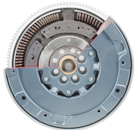
Figur 1: Tomassesvinghjul med sentrifugalpendel
