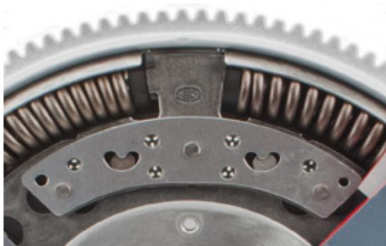
Fig. 2: Pêndulo centrífugo
