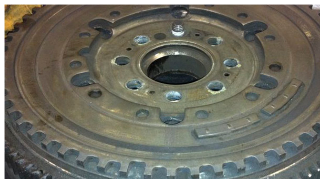
Obrázek 1: Provedení s dosavadním ozubeným věncem
