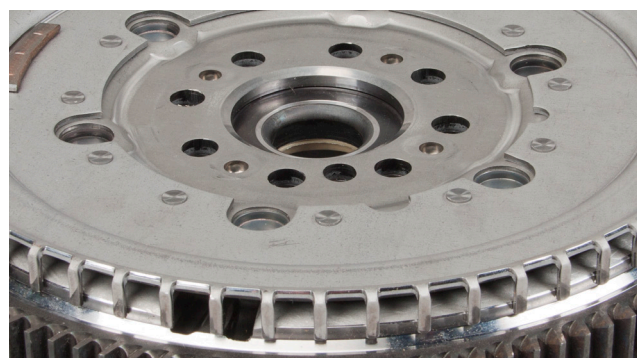
Obrázek 2: Nové provedení ozubeného věnce
