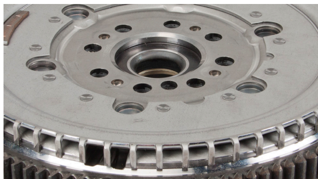
Рисунок 2: Новая конструкция сенсорного кольца
