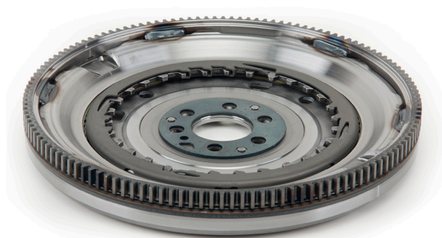
Снимка 1: Броят на зъбите на стартерния пръстен на новата част трябва да съвпада с броя на зъбите на старата част
