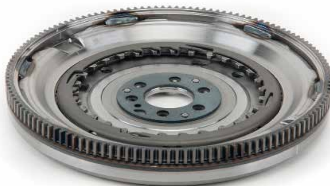
Slika 1: Broj zubaca na prstenu startera novog dijela mora biti isti kao broj zubaca na starome dijelu
