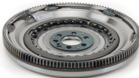
Figur 1: Antall tenner på den nye delens startkrans må stemme med antall tenner på den gamle delens startkrans
