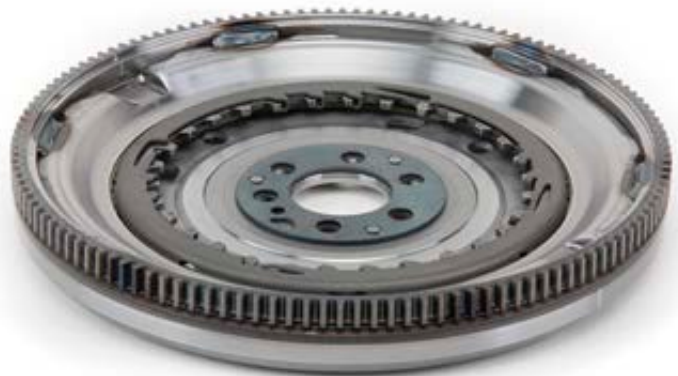
Foto 1: Liczba zębów na wieńcu rozrusznika nowej części musi odpowiadać liczbie zębów na starej części.
