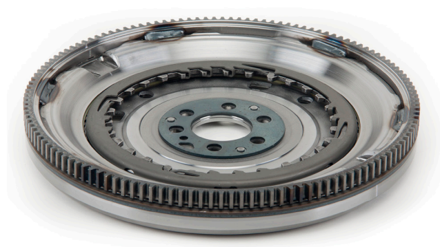
Fig. 1: Numărul de dinți al noii coroane a demarorului trebuie să se potrivească cu cel al vechii coroane.
