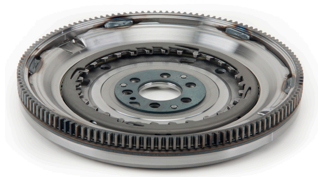
Рисунок 1: Количество зубьев на зубчатом венце нового маховика должно совпадать с количеством зубцов на старом маховике
