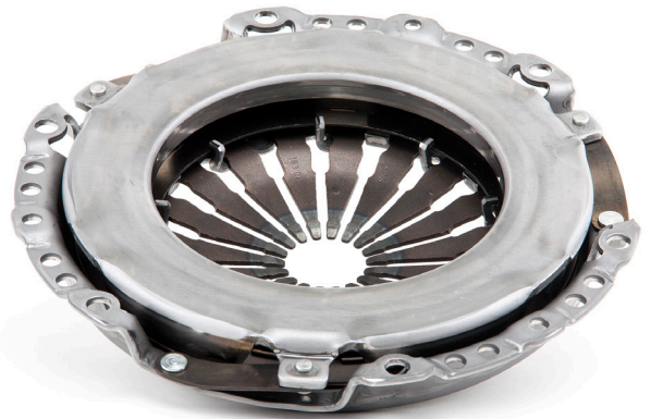
1. ábra: A 620 3268 00 cikkszámú LuK RepSet kuplungszerkezete
