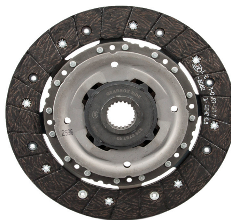
Obrázek 2: Spojková lamela s tlumičem náboje (průměr 228 mm nebo 240 mm)
