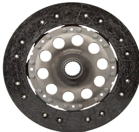
Foto 1: Tarcza sprzęgła z pierwszego montażu OE (średnica 240 mm)
