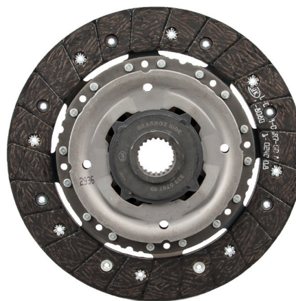
Fig. 2: Disc de ambreiaj cu amortizor butuc (diametru 228 mm sau 240 mm)
