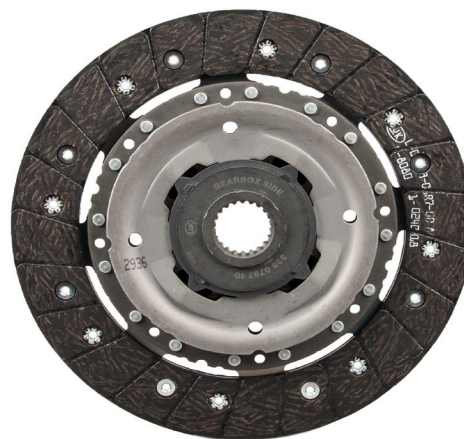
Рисунок 2: Диск сцепления с демпфером на втулке (диаметр 228 мм или 240 мм)
