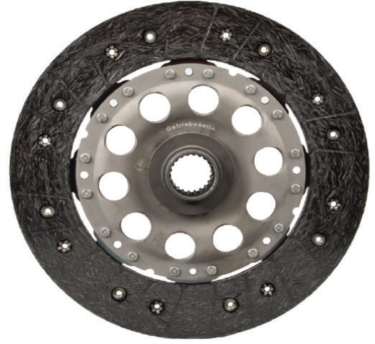
Resim 1: Rijit göbek bağlantılı debriyaj balatası (çap 240 mm)
