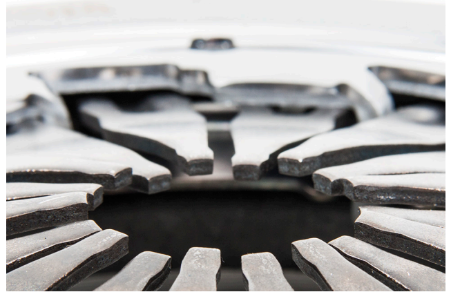
Εικόνα 1: Κακή ευθυγράμμιση χτενιών σε αποσυαρμολογημένο συμπλέκτη
