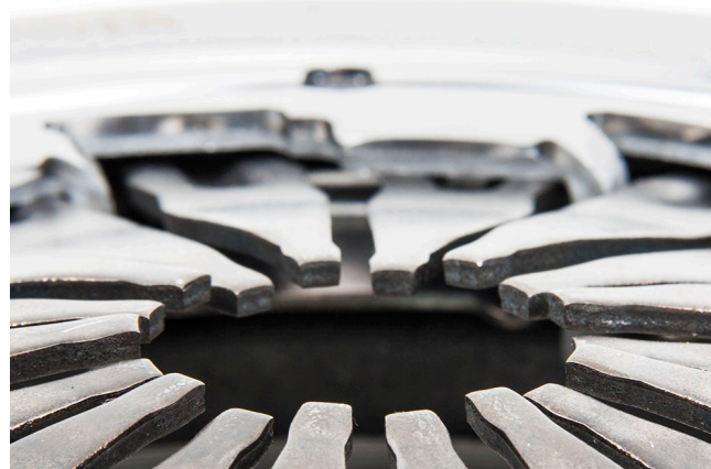
Fig. 1: Nealinierea brațelor elastice ale arcului tip diafragmă la un ambreiaj demontat
