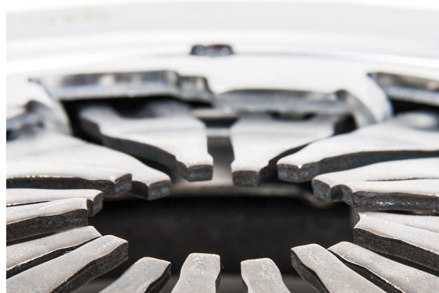
Bild 1: Förskjutning hos solfjäders tungor vid demonterad koppling
