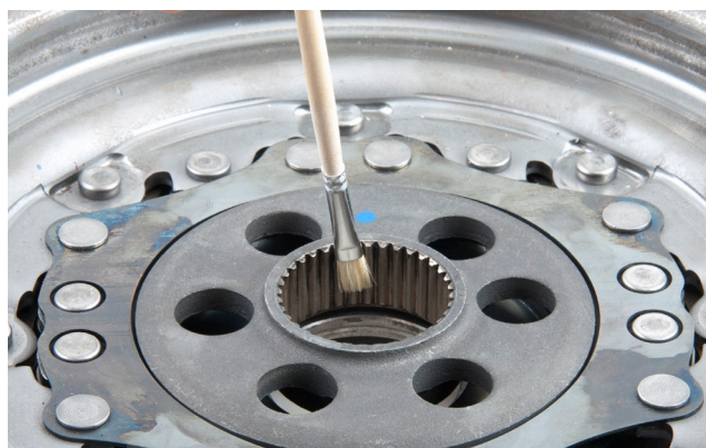
Obrázek 1: Vnitřní ozubení dvoumotového setrvačnicku by mělo být při každé opravě mírně namazáno
