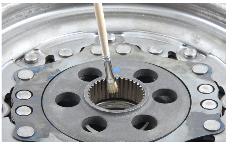
Figura 1: ingrassare sempre leggermente la dentatura interna del volano a doppia massa ad ogni intervento di riparazione
