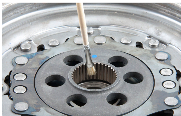
Рисунок 1: Небольшое количество смазки должно быть нанесено на внутренние направляющие шлицы во время обслуживания
