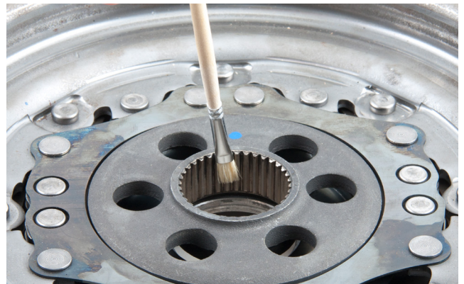
Bild 1: De inre splinesen hos dubbelmassasvänghjulet bör infettas lätt vid varje reparation
