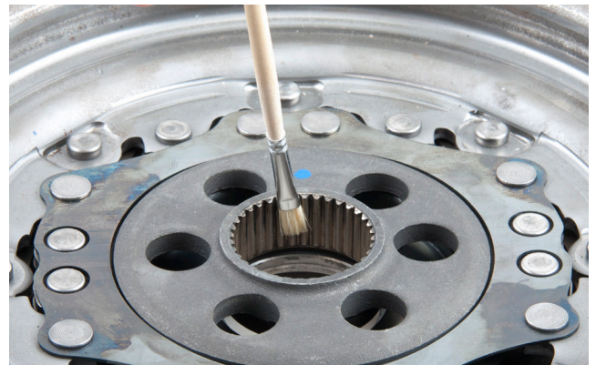
Зображення 1: Кожного разу під час виконання ремонтних робіт необхідно нанести невелику кількість змазки на внутрішні направляючі шліци двомасового маховика
