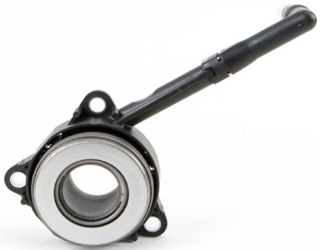
Het hydraulisch druklager moet na een bepaalde periode worden ontluicht
