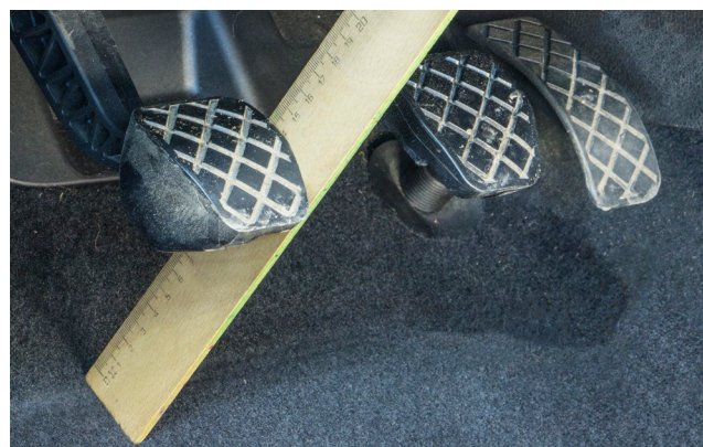
Снимка 1: След смяна на съединителя, регулирайте свободния ход на педала.
