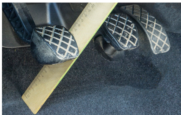
Obrázek 1: Po výměně spojky musí být nastavena vůle pedálu
