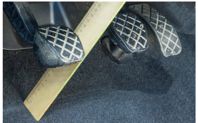
Εικόνα 1: Μετά την αντικατάσταση του συμπλέκτη, ρυθμίστε τον τζόγο του πεντάλ.
