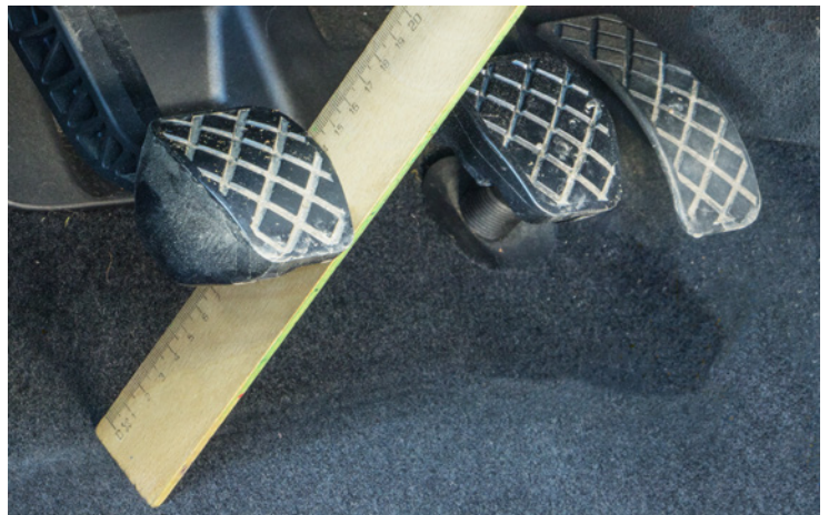
Fig. 1: Tras la sustitución del embrague, se debe ajustar el recorrido libre del pedal.
