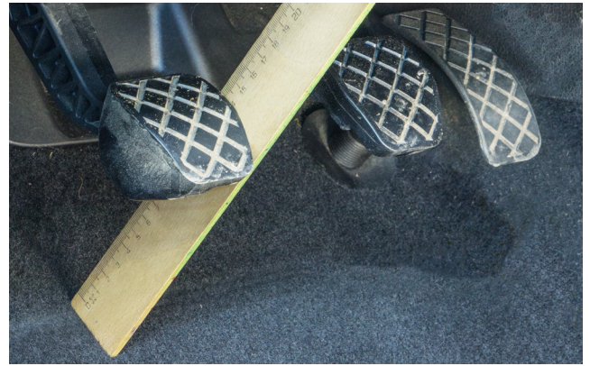
Kuva 1: Kytkimen vaihdon jälkeen on säädettävä polkimen välys
