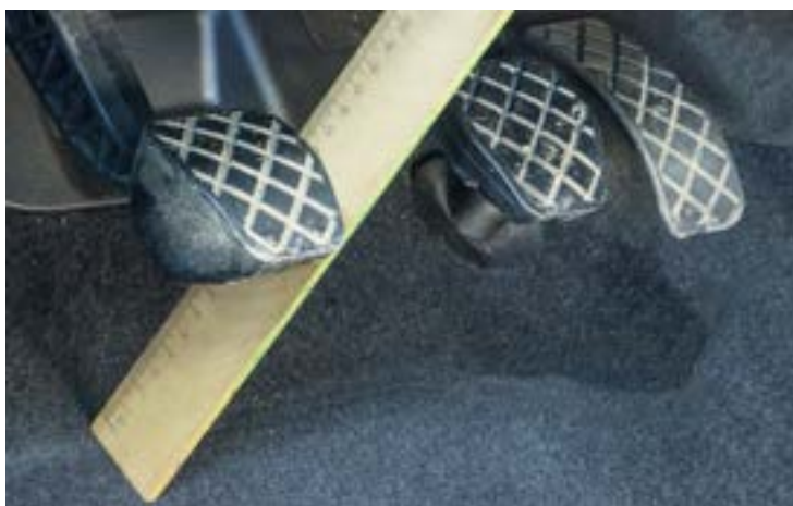
Foto 1: Po wymianie sprzęgła należy wyregulować skok jałowy
