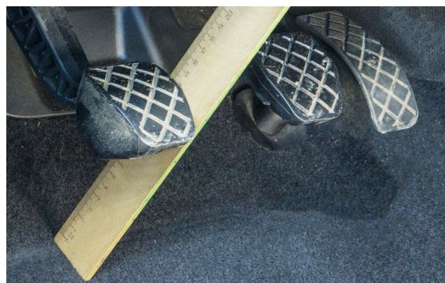
Рисунок 1: После замены сцепления отрегулируйте ход педали.
