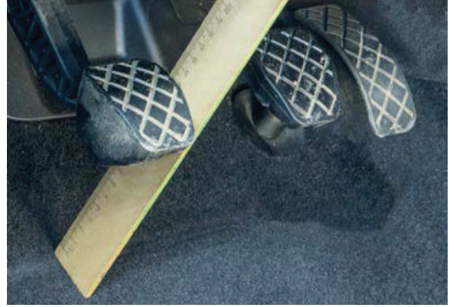
Resim 1: Debriyaj değiştirildikten sonra pedalın durumu ayarlayın.
