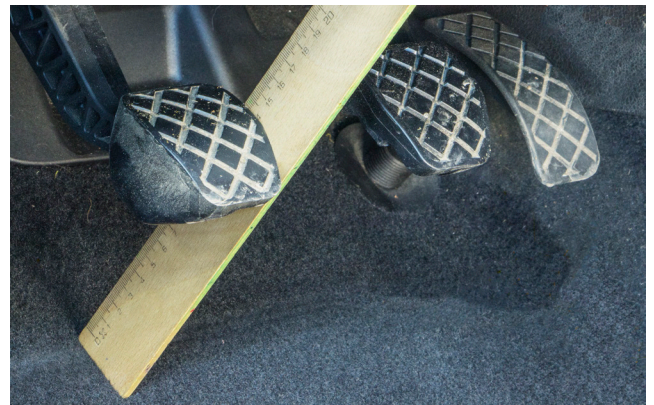
Зображення 1: Після заміни зчеплення необхідно відрегулювати хід педалі зчеплення
