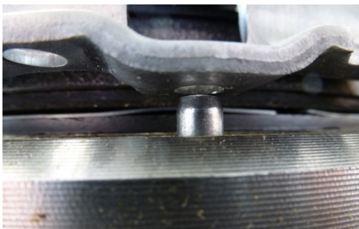
Figura 1: durante il montaggio, i perni di centraggio non si posizionano nei fori
