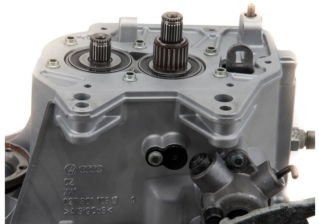
Το σύνολο των διπλών και των μακαρονωτών ρουλεμάν σε κιβώτιο 02T
