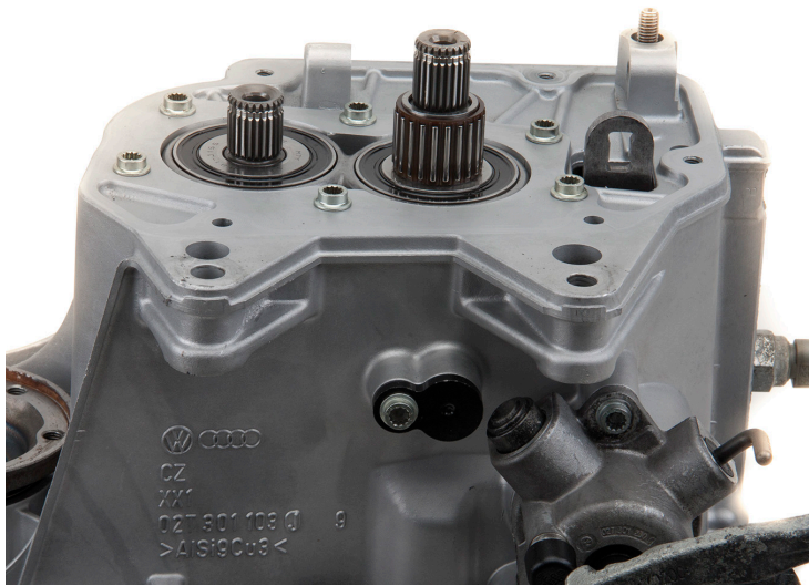
מערך פלטת הידוק "מיסב המשקפיים" ומיסבי המחטים בתיבת הילוכים מסוג 02T
