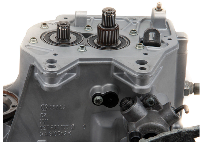
Зображення 1: Вузол подвійного підшипника в трансмісії 02T
