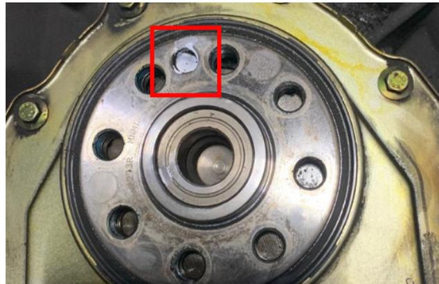
Fig. 2: Marcas de referencia del cigüeñal
