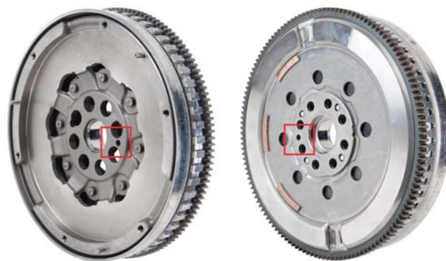
Slika 1: Položaj kontrolnog provrta na zamašnjaku
