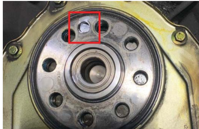
Slika 2: Položaj kontrolnog provrta na prirubnici koljenastog vratila
