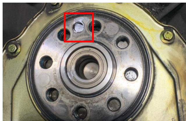
Afbeelding 2: Referentiemarkering van de krukas
