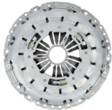
Fig. 1: El plato de presión del RepSets 625 3165 09 (para vehículos anteriores al año de fabricación)
