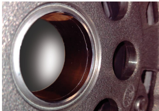
Figura 2: cricca superficiale meno marcata sulla flangia di supporto
