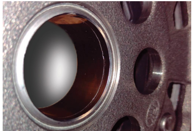
Afbeelding 2: Materiaalvouwing op de lagerflens met geringe profilering
